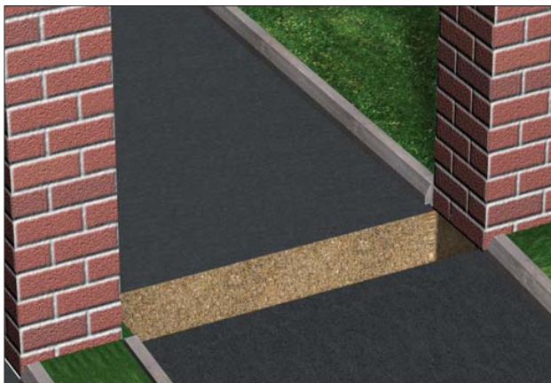
1. Выкопайте котлован 1500x400xВ.
