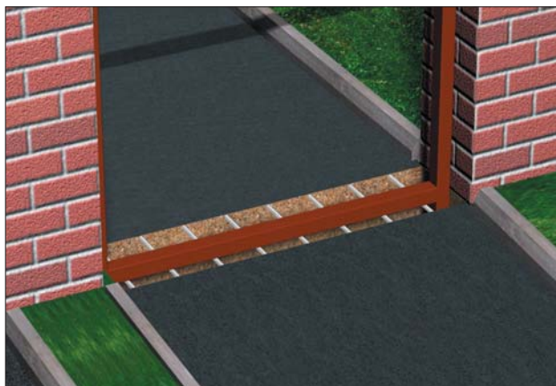
4. Закрепите раму в котловане, используя отрезки арматуры.
